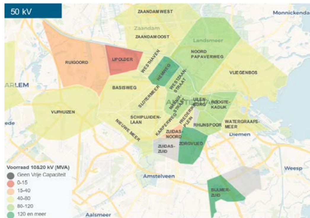
Capaciteit 50 kV onderstations
